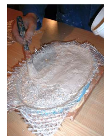
Mouiller la couche avec de l'Acrystal Prima
